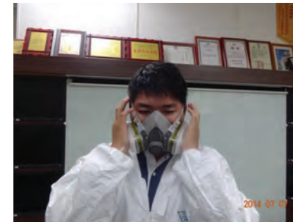
5. 進行氣密測試- 負壓測試
