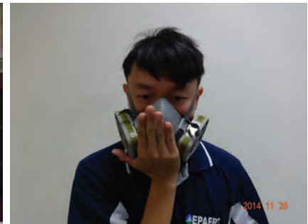
6. 進行氣密測試- 正壓測試
