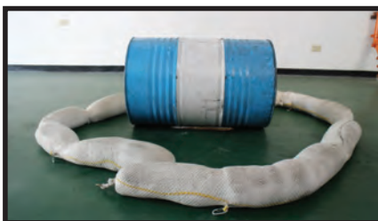
1. 將55加侖鐵桶週遭以吸液綿索進行圍堵。（鐵桶側邊需以木條固定避免滾動）
