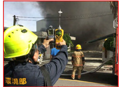
08:45大門口量測VOCs (最高測得440 ppm)
