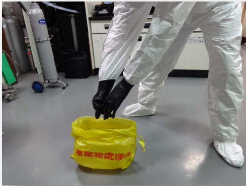
1. 拆除抗化膠帶脫除外層黑色手套
