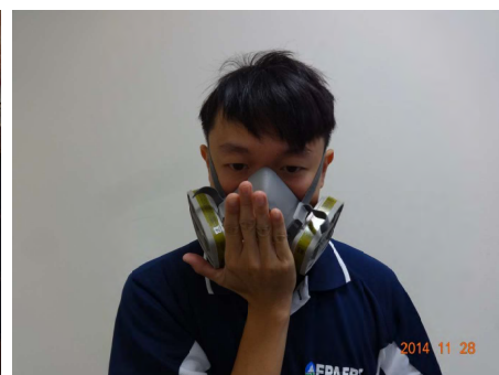
6. 進行氣密測試- 正壓測試
